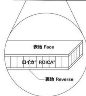
ファイネックス®の構造図 FINEX® structure
